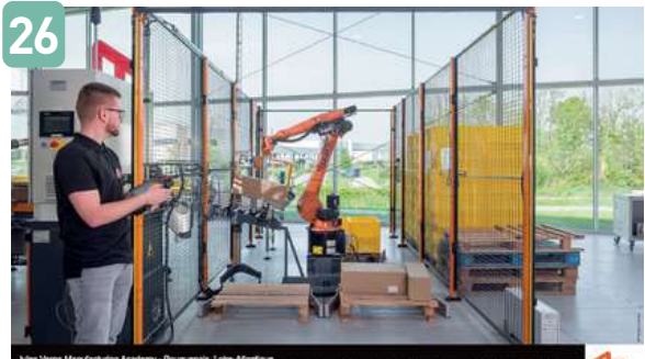
26 Jules Verne Manufacturing Academy - Douzerais, Loire-Atlantique Apprenti d'un établissement scolaire de la région en cours de programmation d'un robot de palettisation de cartons au sein de l'École 4.0.
