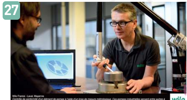
27 Wilo France - Laval, Mayenne Contrôle de conformité d'un élément de pompe à l'aide d'un bras de mesure métrologique. Ces pompes industrielles servent entre autres à l'alimentation des réseaux de chauffage et aux systèmes de refroidissement des rotors d'éoliennes.
