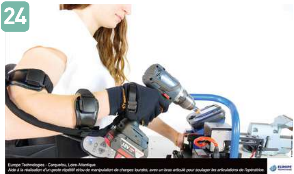
24 Europe Technologies - Carquefou, Loire-Atlantique Aide à la réalisation d'un geste répétitif et de manipulation de charges lourdes, avec un bras articulé pour soulager les articulations de l'opérateur.
