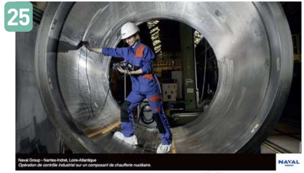
25 Naval Group - Nantes-Indret, Loire-Atlantique Opérateur de contrôle industriel sur un composant de chaudière nucléaire.
