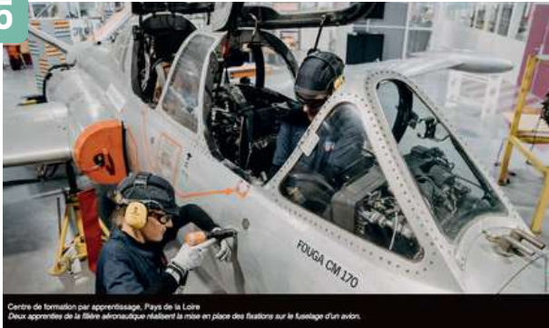
Centre de formation par apprentissage, Pays de la Loire Deux apprentis de la filière aéronautique réalisent la mise en place des flutons sur le fuselage d'un avion.
