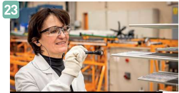
23 Framatome - Painlevé, Loire-Atlantique Une technicienne vérifie des barres de zirconium à l'atelier «finition et contrôle visuel».
