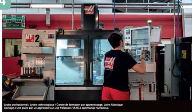
Lycée professionnel / Lycée technologique / Centre de formation par apprentissage, Loire-Atlantique Usinage d'une pièce par un apprenant sur une fraiseuse HAAS à commande numérique.
